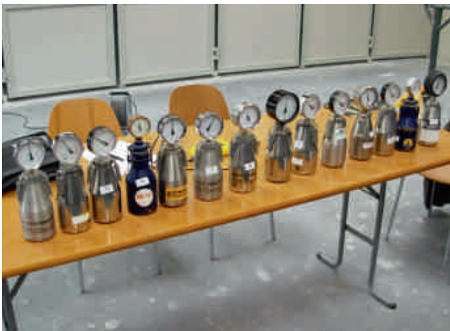
Zur Messung der Feuchtigkeit des Zementestrichmörtels füllten die Teilnehmer das Probenmaterial in die vorbereiteten Druckbehälter.
