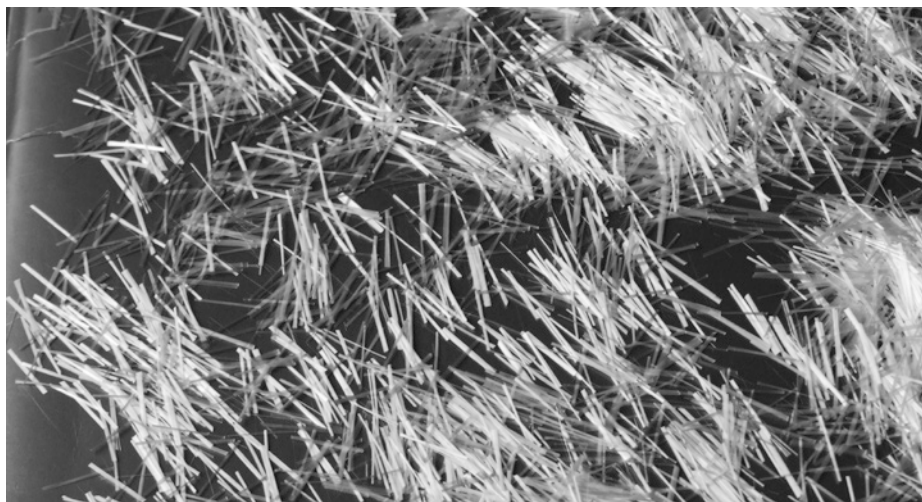
DELTA XT ist eine E-Glasfaser für Estriche, lieferbar in den Längen von 6, 12 oder 25 mm, die zur Rissminimierung verwendet wird. Dank guter Konsistenz und optimalem Verteilungsverhalten gelangen die Fasern nicht an die Oberfläche des Estrichs.
