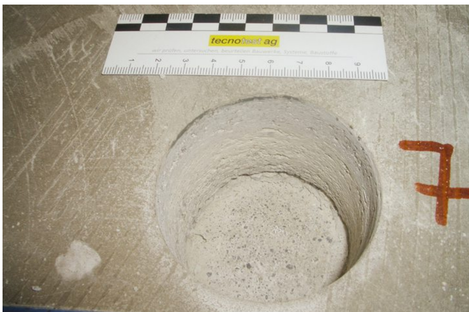
Festigkeitsprüfungen an Bohrkernen aus Estrichen sind nach neuer Norm SIA 251:2008 nicht mehr zulässig.
