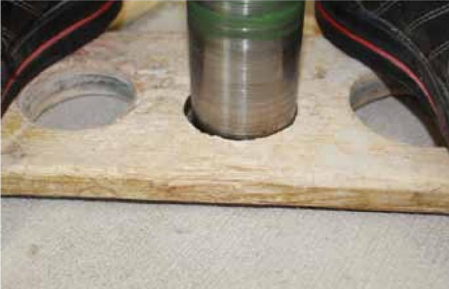
Weichen die vom Belags- und dem Estrichunternehmer durchgeführten Feuchtigkeitsmessungen zu weit voneinander ab, wird oft eine dritte, neutrale Messung angeordnet. Auf dem Bild: Entnahme einer Estrichprobe mit Hilfe eines Trockenbohrers.
