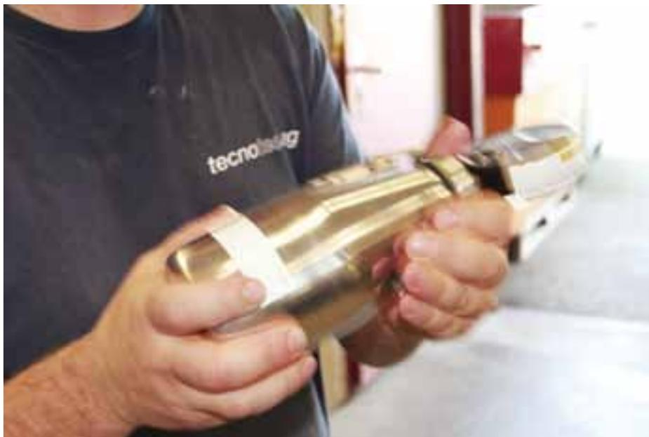
Messung des Feuchtigkeitsgehalts mittels CM-Methode.
