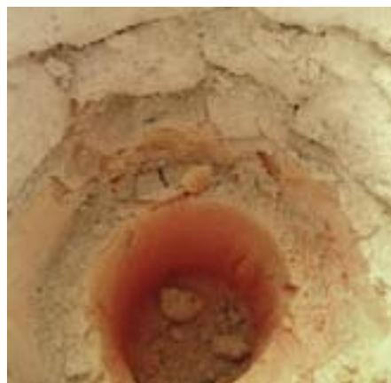
Ein Fliessestrich darf bei der Materialentnahme mit der Bohrkernmaschine nicht zerfallen.
