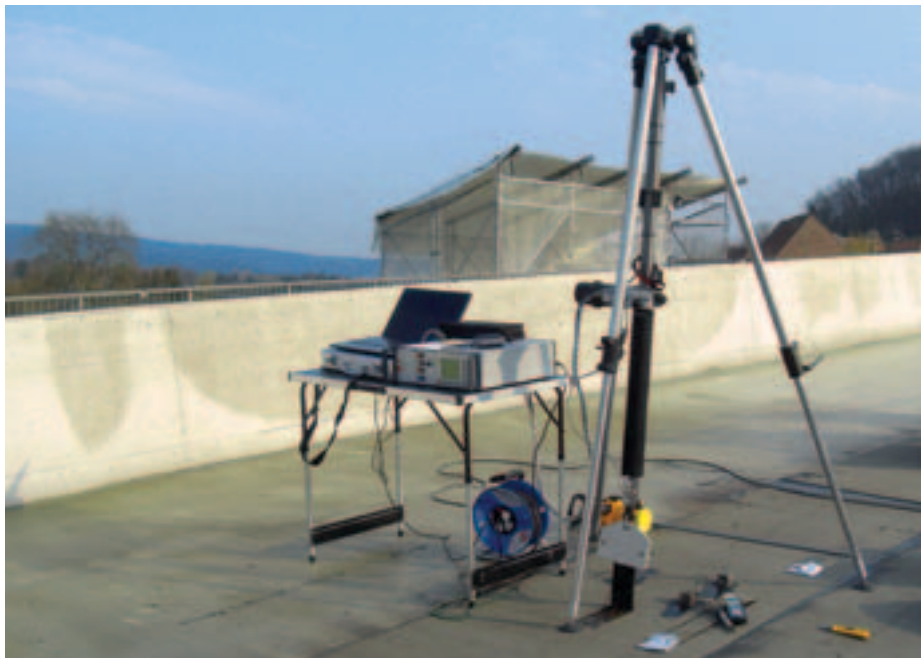
Schälzugprüfung am Objekt.
