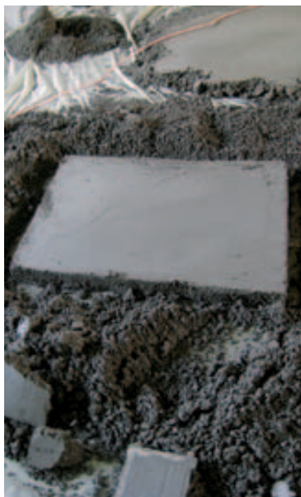
«Ausstechen» der Probeplatte aus dem korrekt verdichteten Mörtel.
