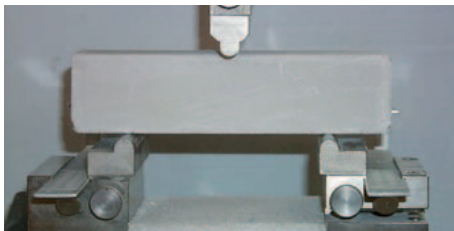
Beispiel einer Biegezugfestigkeitsmessung.
