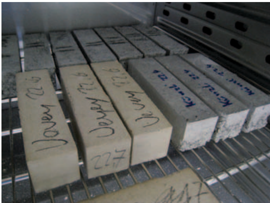
Lagerung im Klimaschrank. Die Lagerung muss protokolliert werden.
