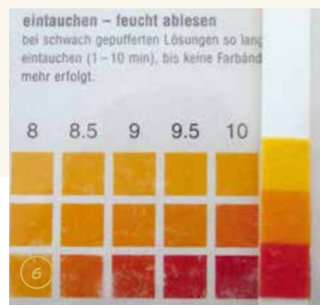
Bild 6: Die Flüssigkeit in Osmoseblasen ist in der Regel aufgrund des meistens vorliegenden Calciumhydroxid (Ca(OH) 2 ) leicht bis stark alkalisch, im vorliegenden Fall mit dem pH-Wert 10 eher leicht alkalisch.
