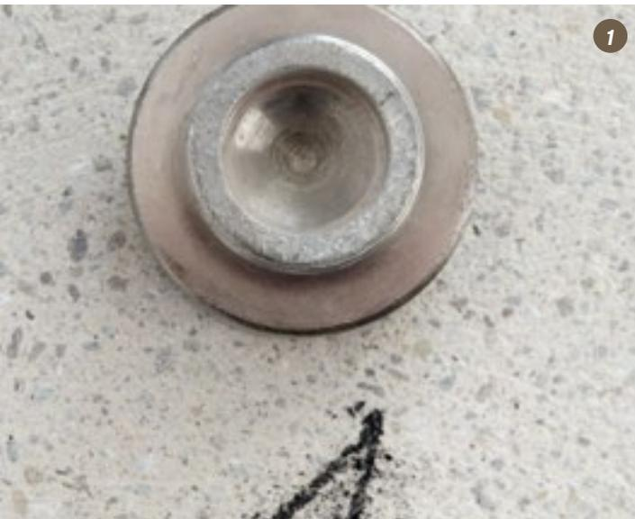
**1: Sauber geschliffener und entstaubter Untergrund mit aufgeklebtem Stahlabzugstempel. Resultat genügend.**
