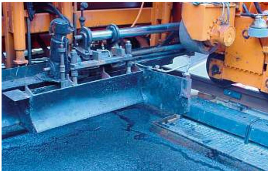
Die Einbaubohlen sind mit Extenserböhlen ausgerüstet, so dass die Einbaubreite Zentimeter genau eingestellt werden kann.
