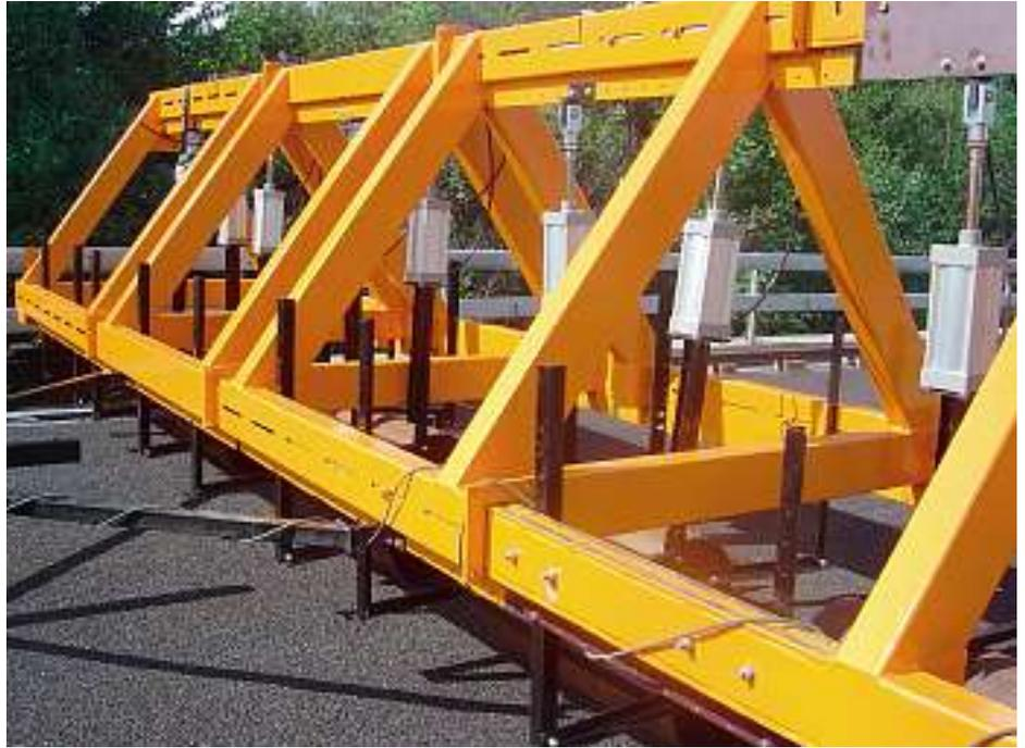
Glattmantelwalzen des NBG, welche mit Pneumatikzylindern belastet werden.
