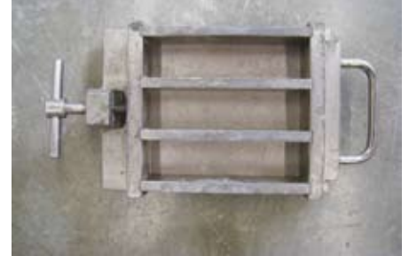
Prismenschalung zur Herstellung von Prismen 160/40/40/ mm.
