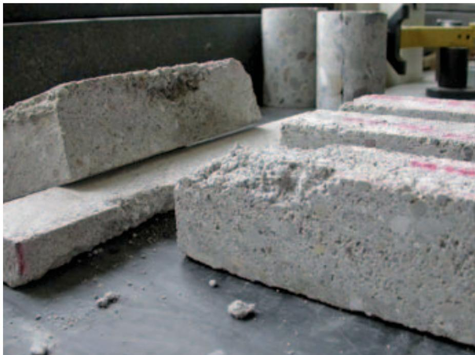
Abgebrochene Ecke an einem Prüfprisma.
