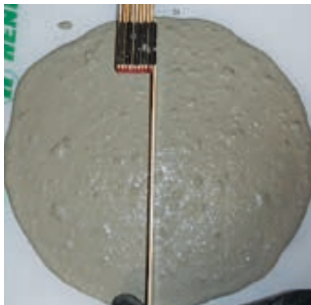
Zementestrich - fließfähig beim Einbau; feuchtigkeitsunempfindlich im eingebauten Zustand.
