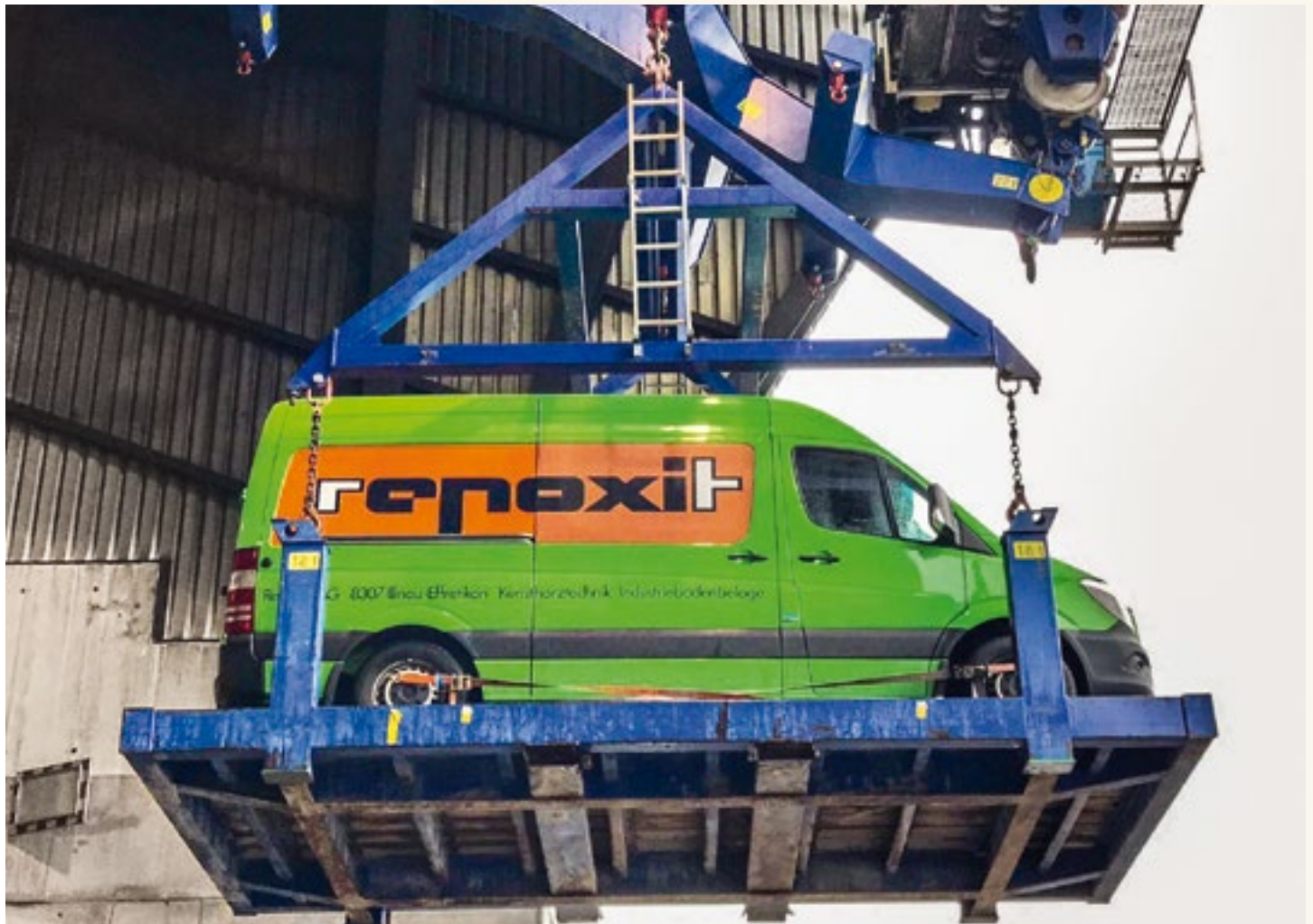
Fahrzeugtransport mit Transportseilbahn zum Umschlagplatz auf 1700 Meter über Meer.
