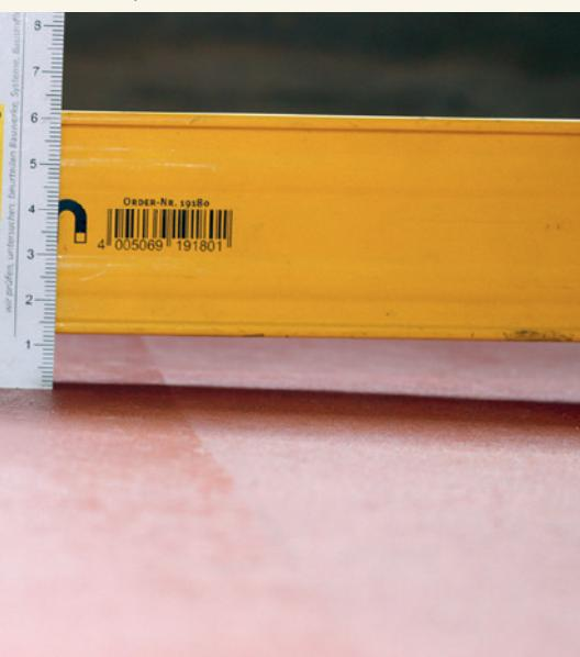
**Fig. 2:** Mesure du tuilage à une distance maximale de 1m.
