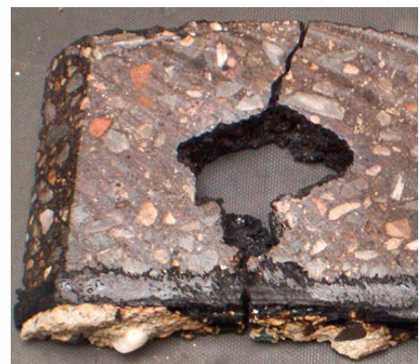
Bild 2: Blase, entstanden durch Dampf der aus dem Beton durch die Abdichtung in den Gussasphalt durchgeströmt ist.
