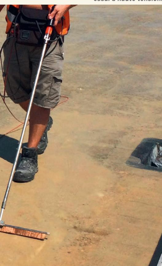
**Photo 3:** Le scellement en résine synthétique est contrôlé au moyen d'un essai à haute tension.
