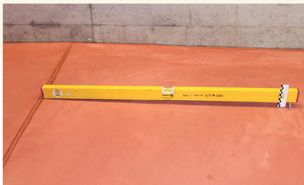
**Abb. 2:** Messung der Aufwölbung in einem Abstand von max. 1m.
