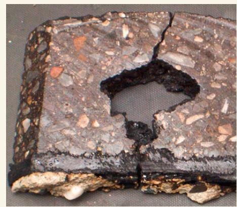
**Photo 2:** Boursouflure créée par la vapeur qui s'est échappée du béton et a traversé l'étanchéité dans l'asphalte coulé.
