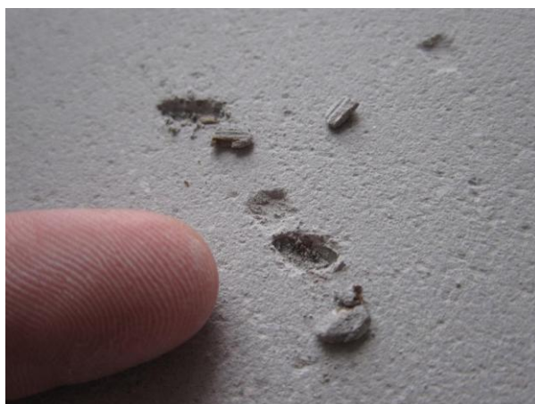
Holzeinschlüsse! Holz im Sand ist nicht immer zu verhindern und muss, bis zu einem gewissen Grad, akzeptiert werden können.
