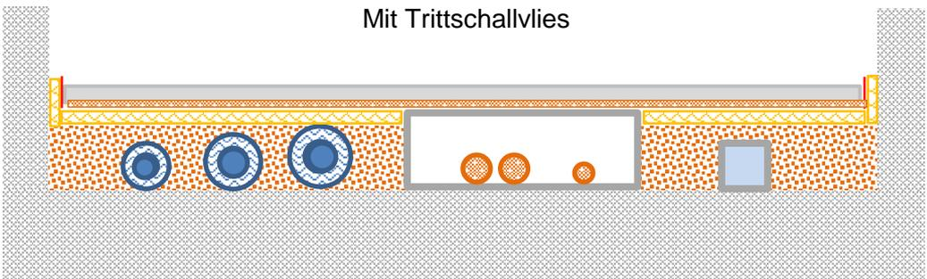
Darf nur ausgeführt werden, wenn  $d_L - d_B$  des Ausgleichmörtels inkl. der Dämmung 0 mm ist und auch bleibt. Nur sehr geringer Trittschallschutz möglich. Die Deformation des Trittschallvlieses  $d_L - d_B$  sollte 3 mm nicht übersteigen.
