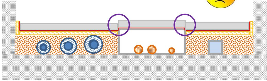
Wenn sich die Dämmung zusammendrückt (Deformation) wird der Estrich reißen und «durchstanzen».
