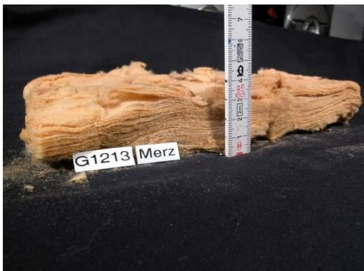
Übermässig grosse Absenkungen bilden sich, wenn die Dämmschicht infolge Feuchtigkeitseinwirkung zerfällt (Abb. 11).
