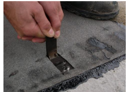
Schälzugprüfung von Hand
