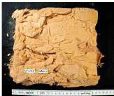
Mineralwolleplatten können sich infolge Feuchtigkeit zersetzen. Unter ausreichend alkalischer Feuchtigkeit kann sich die Platte bis zur vollständigen Auflösung zersetzen.
