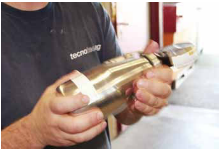
Messung des Feuchtigkeitsgehalts mittels CM-Methode.
