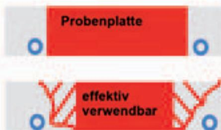
Oft ist die ausgebaute Platte in der unteren Randzone unvollständig verdichtet und teilweise aus- oder abgebrochen, so dass nur ein Teil der Probepplatte verwendet werden kann.
