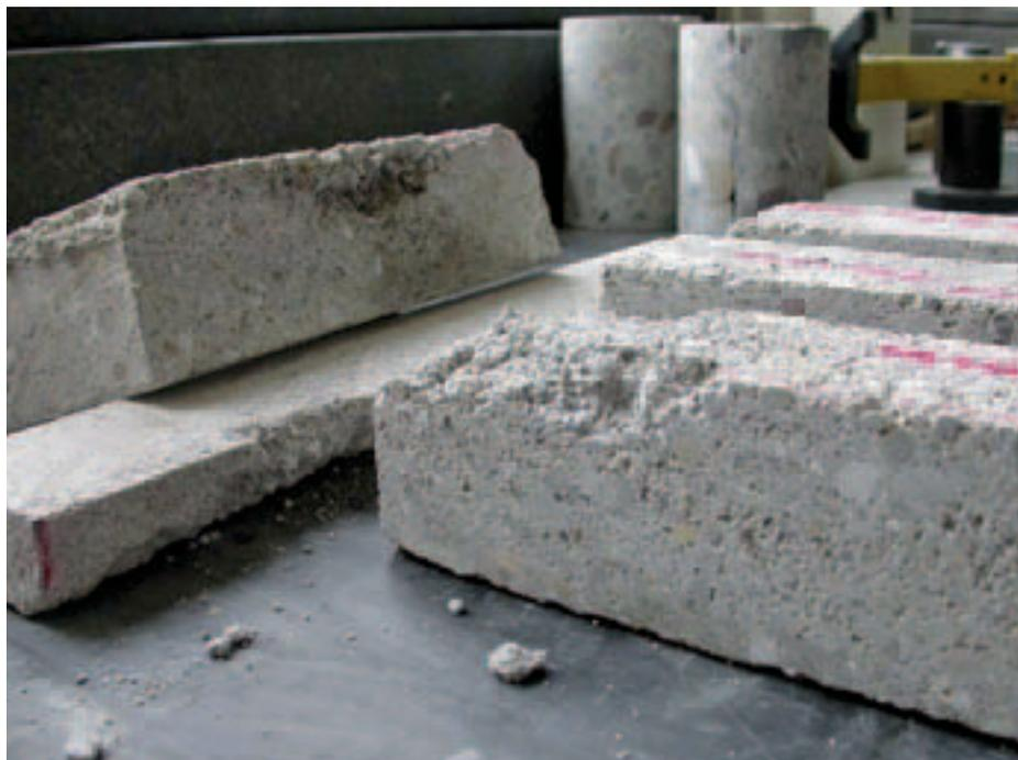
Abgebrochene Ecke an einem Prüfprisma.
