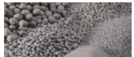
... und Blähglas sind mögliche Zuschlagstoffe.
