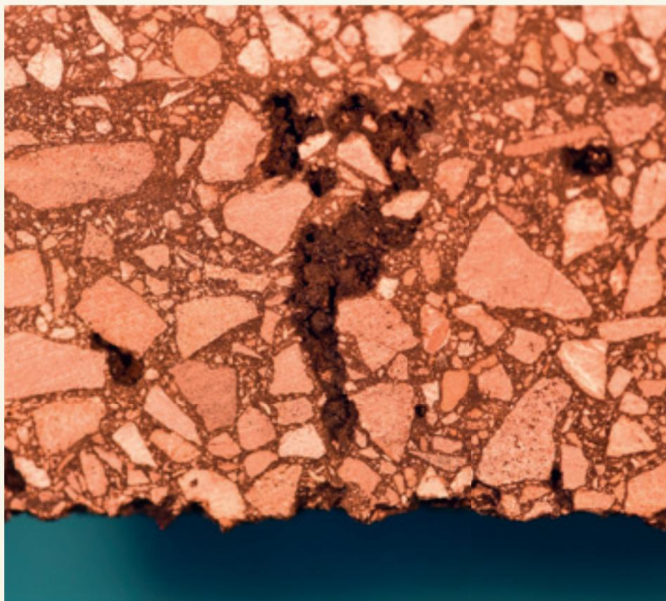
À droite: formation de cloques dans l'asphalte coulé au-dessus du dommage dans la ESL.
