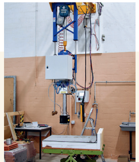
Canon à grêle de p+f Sursee au-dessus de la structure du système à tester.
