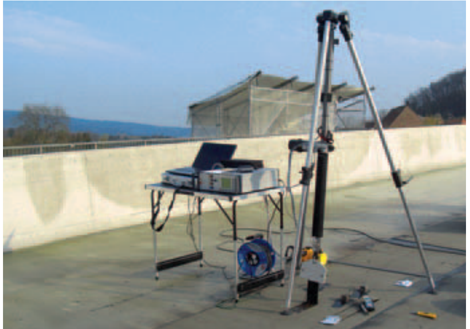
Schälzugprüfung am Objekt.
