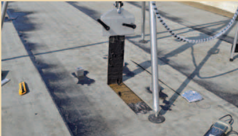
Essai de pelage par traction.
