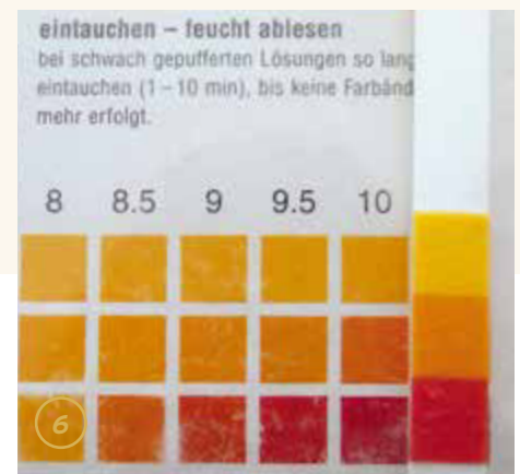
Bild 6: Die Flüssigkeit in Osmoseblasen ist in der Regel aufgrund des meistens vorliegenden Calciumhydroxid (Ca(OH) 2 ) leicht bis stark alkalisch, im vorliegenden Fall mit dem pH-Wert 10 eher leicht alkalisch.
