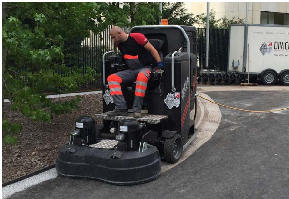
Oberflächenbearbeitung von Asphalt- und Betonbelägen mit dem System Divico Kleweg.
