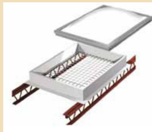
Bild 3: Gittereinlage als Absturzicherung bei einer Lichtkuppel (Bild: Plasteco). Image 3: Grille anti-chute installée dans une coupole d'éclairage (photo: Plasteco).
