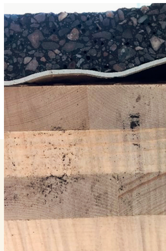
Abbildung 1: Schnittbild einer Blase zwischen der PMMA-Abdichtung und der Holzunterlage.
