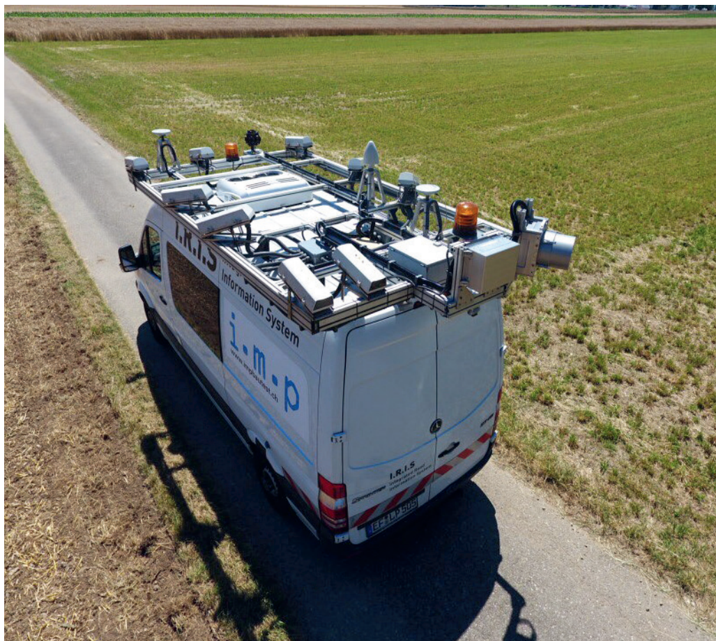
Abbildung 4: Monitoring des Blasenwachstums mit Laser-Technologie. Oben: Messfahrzeug mit LIDAR-Scanner und Positionierungssystem. Unten: Beispiel einer Fläche mit Blasen.
