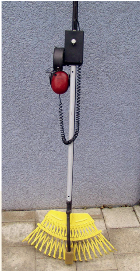
Abbildung 3: Akustische Prüfung; Erkennen von Blasen in PBD mittels Laubrechen.
