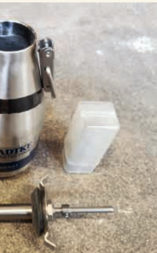
Figure 4: Flacon CM avec échantillon de 50 g, jeu de billes et barre de broyage, prêt pour le pré-broyage de l'échantillon avant la réaction chimique.
