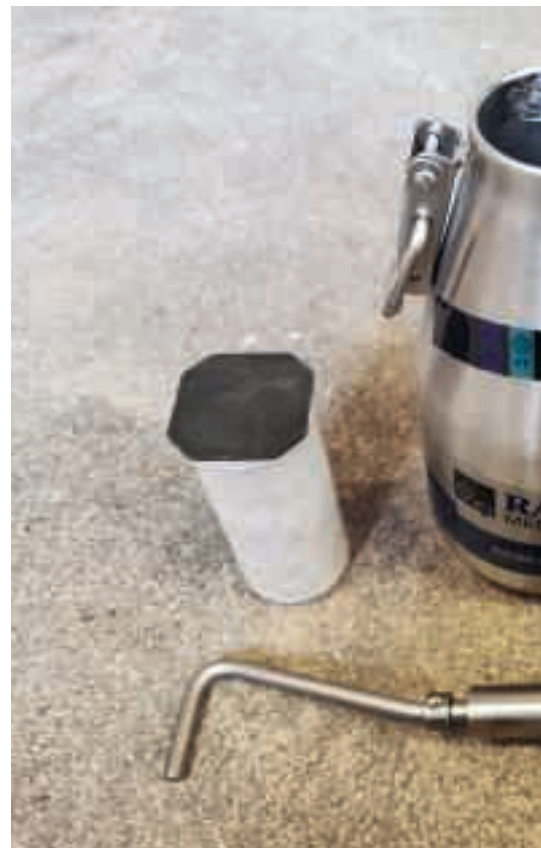
Abbildung 4: CM-Flasche mit 50g Probe, Kugelsatz und Zerkleinerungsstab, bereit für die Vorzerkleinerung der Probe vor der chemischen Umsetzung.
