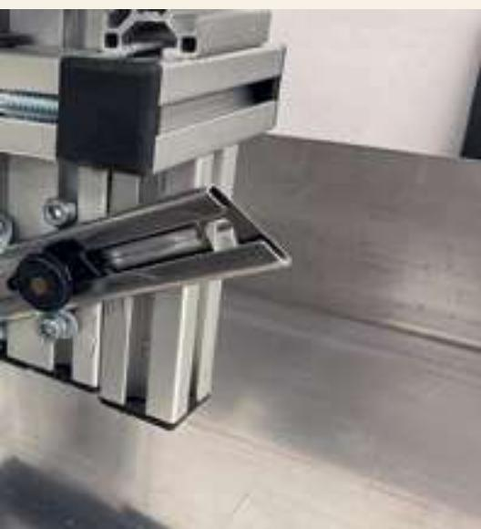
protection contre les dommages de coupe à la pénétration d'un outil de coupe. La protection contre les coupures appliquée sur une couche d'étanchéité est soumise à une charge définie sur l'outil de coupe. La charge sur l'outil de coupe est augmentée jusqu'à la défaillance de la protection contre les dommages de coupe.
