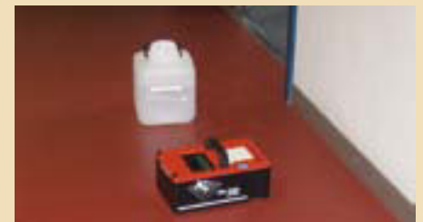
L'appareil de mesure du glissement FSC 2000 print permet par exemple de déterminer les coefficients de frottement entre un revêtement de sol et des échantillons de matériaux pour semelles de chaussures. Photo: Euböolithwerke AG Spiez.
