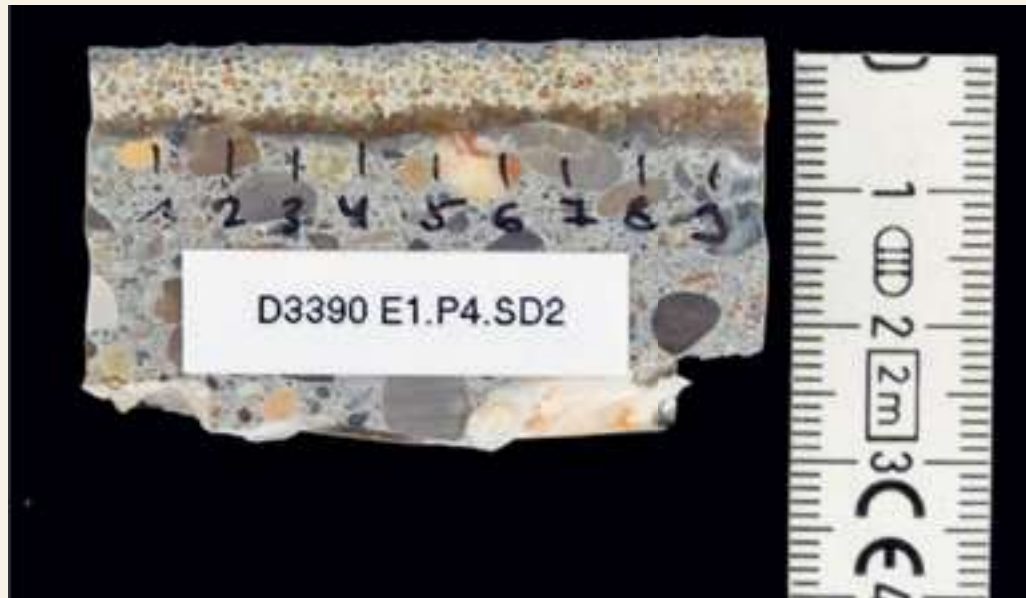
Schichtdicke des Parkdecksystems am Anschliff bestimmt.
