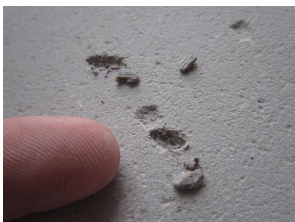
Inclusions de bois! La présence de particules de bois dans le sable n'est pas toujours évitable et doit, dans une certaine mesure, être acceptable.
