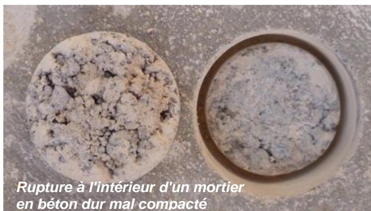
*Rupture à l'intérieur d'un mortier en béton dur mal compacté*
