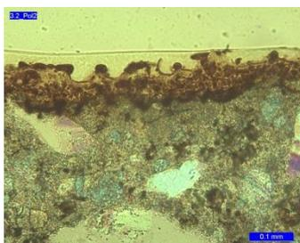
*Image 2 : Surface de béton de l' image 1 en coupe fine. La surface du béton est recouverte d'une couche de carbonate et d'une couche de fond à base de bitume.*
