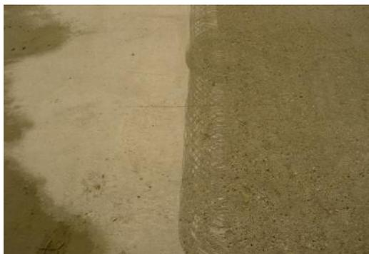
*Côté gauche non traité, côté droit sablé à l'eau sous haute pression 1000 bars.
