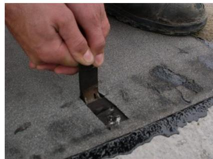
Test manuel de résistance à la traction
