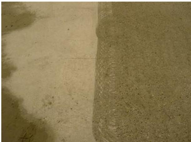
*Sul lato sinistro la superficie non trattata, su quello destro la superficie sabbiata ad acqua ad alta pressione a 1000 bar. Il risultato: forza di adesione ancora insufficiente.*
